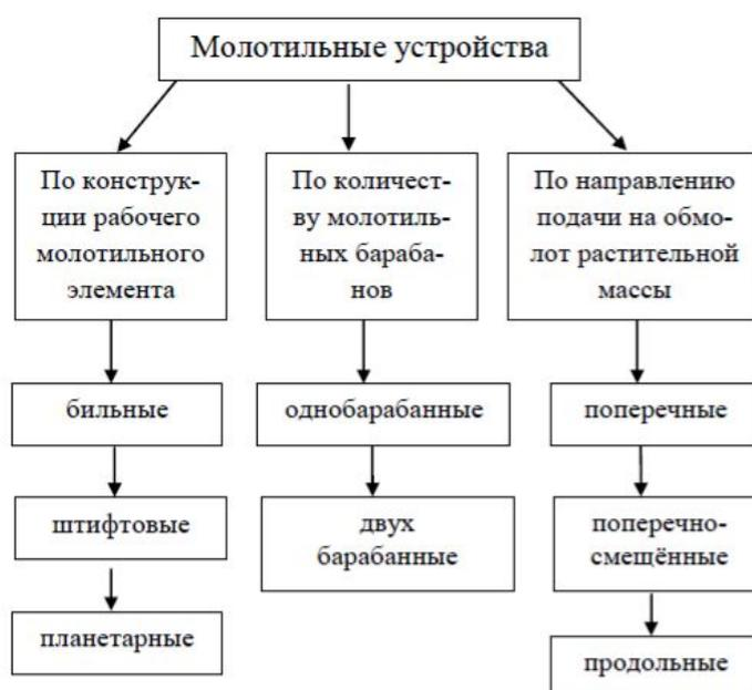
Рис.1. Классификация молотильных установок
