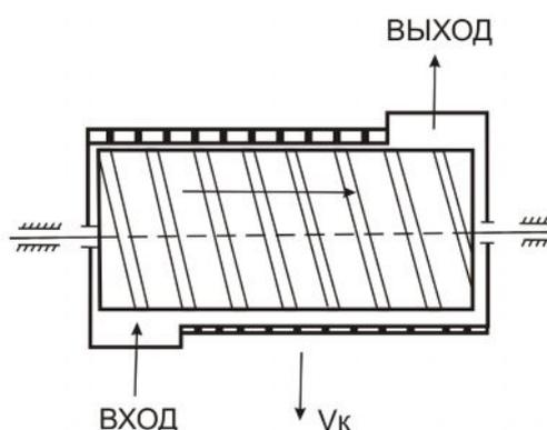
Рис. 4. Поперечно-смещённое молотильное устройство
