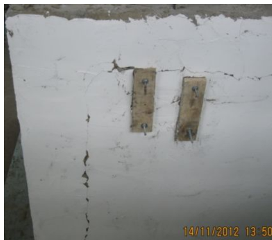
9-Сүрөт. Темир –бетон өзөктүү жана өзөктүн аралыгы саман аралашкан ылай менен толтурулган үйдүн эксперименттен кийинки жалпы көрүнүшү
