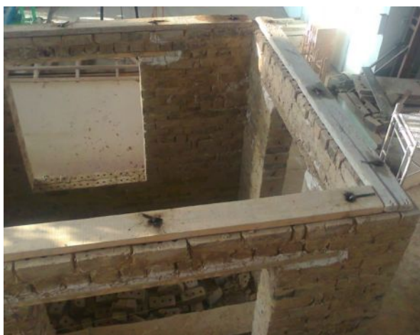
3-Сүрөт. «Жер титирөөгө туруктуу курулуш» лабораториясында чийки кыштан тургузулган үйдүн модели
