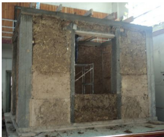
8-Сүрөт. Темир –бетон өзөктүү жана өзөктүн аралыгы саман аралашкан ылай менен толтурулган үйдүн моделин тургузуунун ыкмалары
