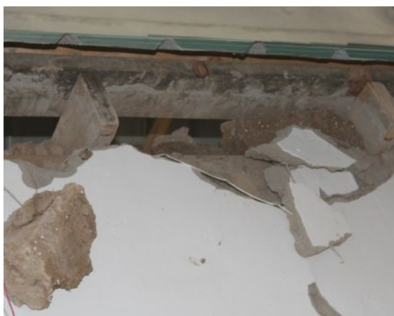
7- Сүрөт. «Сынч» түрүндөгү үйдүн моделинин эксперименттен кийинки учуру
