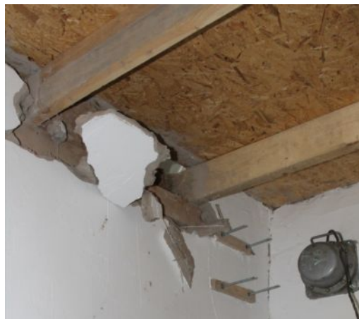
7- Сүрөт. «Сынч» түрүндөгү үйдүн моделинин эксперименттен кийинки учуру
