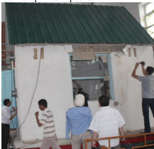
4-Сүрөт. Эксперименттен кийинки, чийки кыштан тургузулган үйдүн модели
