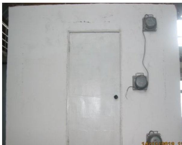
9-Сүрөт. Темир –бетон өзөктүү жана өзөктүн аралыгы саман аралашкан ылай менен толтурулган үйдүн эксперименттен кийинки жалпы көрүнүшү
