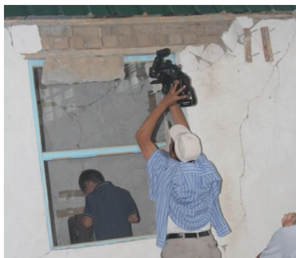
4-Сүрөт. Эксперименттен кийинки, чийки кыштан тургузулган үйдүн модели
