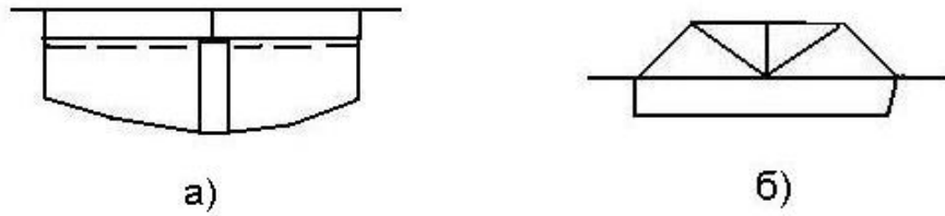
Рис. 3. Мосты. Конструкции ферм: (б) более сейсмостойчивые, чем балочные (а)
