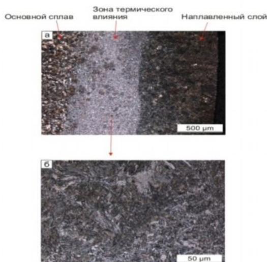
Рис. 4. Микроструктура зоны термического влияния при разных увеличениях: а - × 50, б - × 500.
