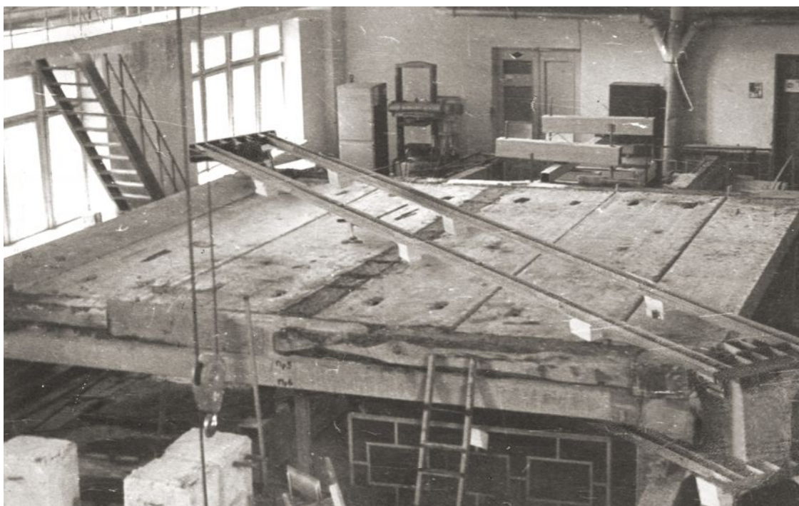
Рис. 6.2.1. Схема испытания фрагмента перекрытия размером 6х6 м. на диагонально-сжимающую нагрузку.
