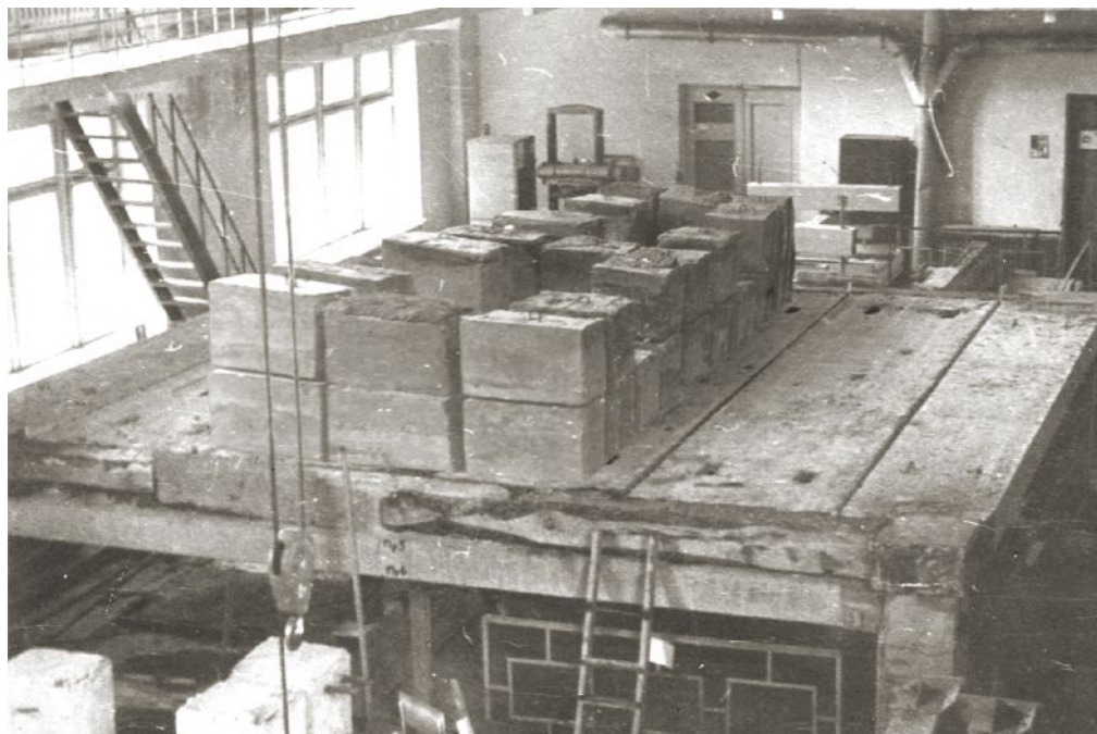
Рис. 6.1.2 Загружение фрагмента бетонными блоками по средним плитам
