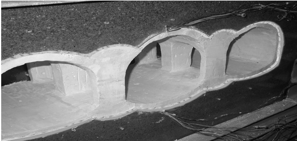
Рис. 2. Сооруженный типовой участок модели станции
