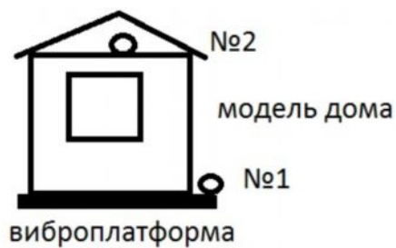
Рис. 4. Схема расположения приборов на модели дома: № 1 – виброплатформа; № 2 – уровень покрытия
