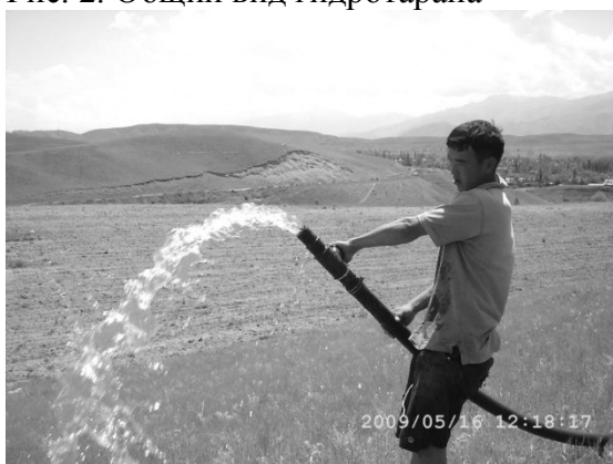
Рис. 4. Выход воды на высоту 35 м
