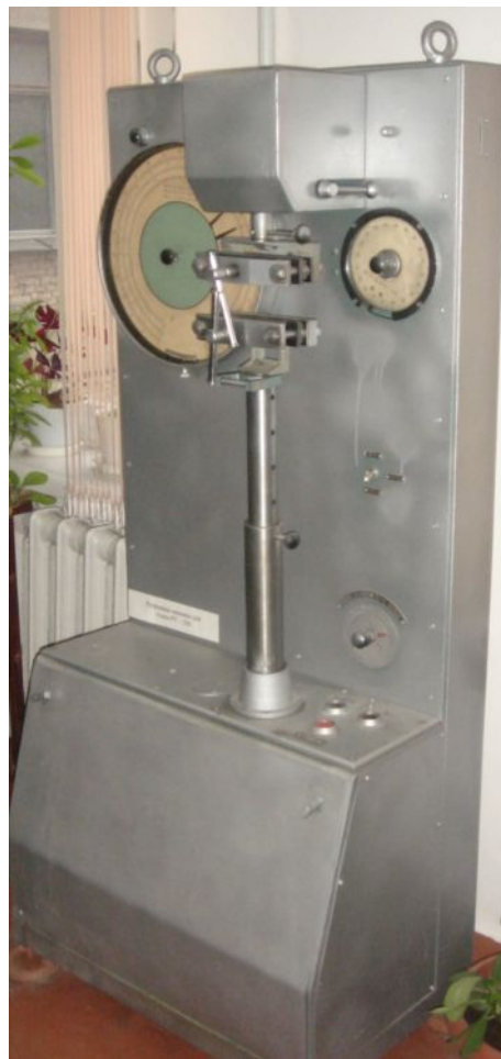
Рис. 16. Разрывная машина РТ – 250 М – 2: а – схема; б – общий вид.
