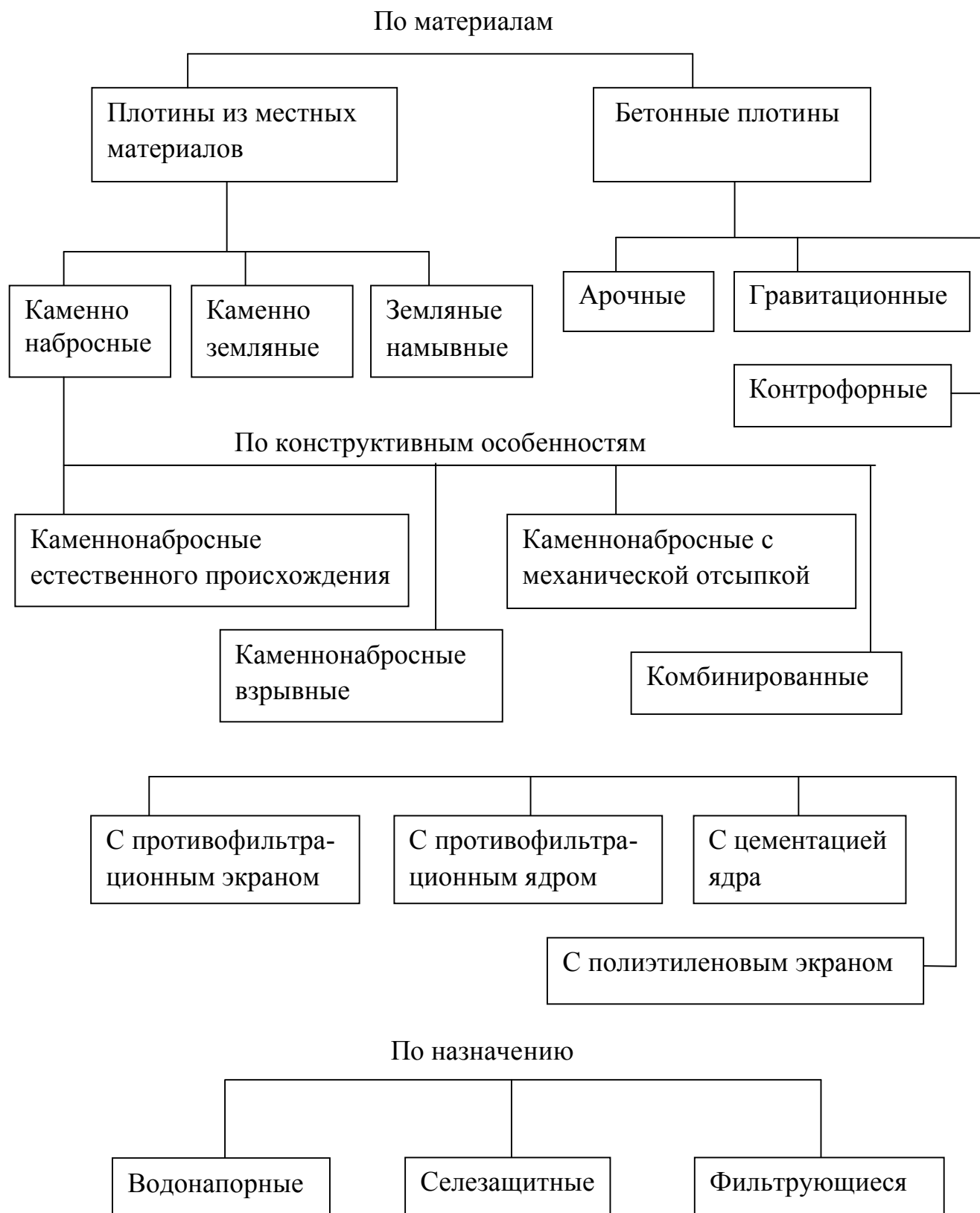
Рис. 1.1. Типы и конструкции плотин
