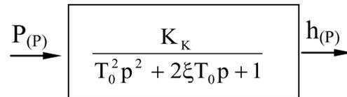
При известных исходных данных несложно рассчитать и получить в виде графиков переходную характеристику регулятора расхода. Аналогично для пропускной щели, зная уравнение расхода  $Q = k_g h$ , устанавливается передаточная функция в виде
