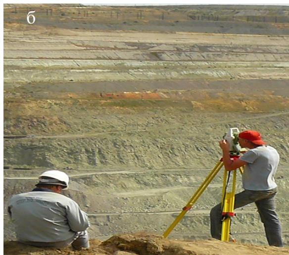
Рисунок 2 – Производство измерений с помощью электронного тахеометра:
