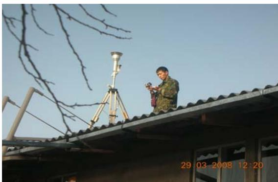
Рис. 17. Измерение массовой концентрации аэрозоля с помощью ТЕОМ на ЛСТ.
