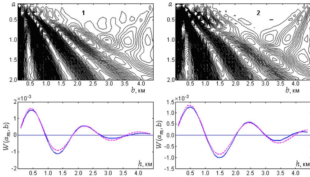
Рис. 9. Спектры коэффициентов вейвлет-преобразований флуктуаций коэффициента  $\beta_a$  (верхние рисунки), профили спектра (сплошная линия на нижних рисунках) и их аппроксимации (пунктир) в фиксированном сечении масштабного коэффициента  $a_m$  для августа (1) и февраля (2) 2004 г. Теплоключенка.
