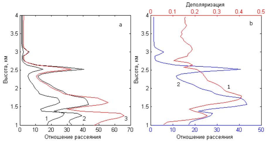
Рис. 2. Вертикальные профили отношения рассеяния  $R(h)$  (a) на трех длинах волн: 1 –  $\lambda=355$  нм, 2 –  $\lambda=532$  нм, 3 –  $\lambda=1064$  нм и совмещенные кривые деполаризации  $D$  (1) и отношения рассеяния (2) на длине волны 532 нм. Пыль. 03:56 ч. 08.08.03.
