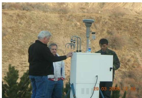
Рис. 18. Автоматический пробоотборник нано- и микромасштабных частиц URG-3000 ABC на ЛСТ.
