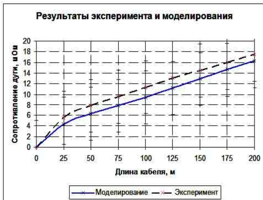
Рис.7. Экспериментальная зависимость сопротивления дуги от длины кабеля с медными жилами за трансформатором 160 кВА и зависимость, полученная при моделировании
