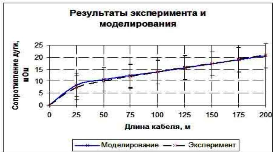
Рис.6. Экспериментальная зависимость сопротивления дуги от длины кабеля с медными жилами за трансформатором 630 кВА и зависимость, полученная при моделировании
