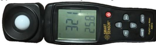
Рис. 1 Люксометр фирмы Smart Sensor
