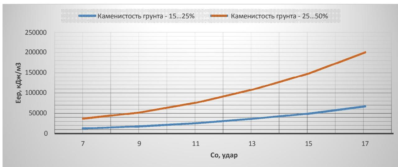
Рис. 7. Изменение общей вероятностной энергоемкости резания грунта с различными каменными включениями, разрушающегося по различной схеме разрушения в зависимости от прочности грунта
