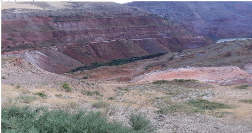
Фото.1. Разрез угольного месторождения Алмалык. Условия залегания угольных пластов при добыче сопряжены с георисками обрушения бортов карьера, затоплением разреза атмосферными осадками и выклиниванием грунтовых вод. Фото. Туркбаева П.Б. (полевые обследования с Какитаевым К.К. 14 августа 2017 г.). Ошская область. Наукатский район.
