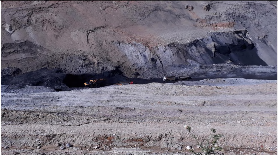
Фото.2. Разрез угольного месторождения Кара-Кече. Условия разработки угольных пластов при добыче сопряжены с георисками обрушения бортов карьера, Фото. Туркбаева П.Б.(полевые обследования с Какитаевым К.К. и Усупаевым Ш.Э. 18 августа 2017 г).Нарынская область. Жумгалский район.
