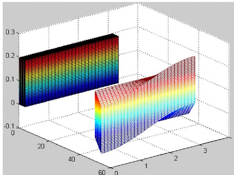
Рис. 1. Кручение при  $c=0.28\text{ГПа}$ . Слева начальное состояние
