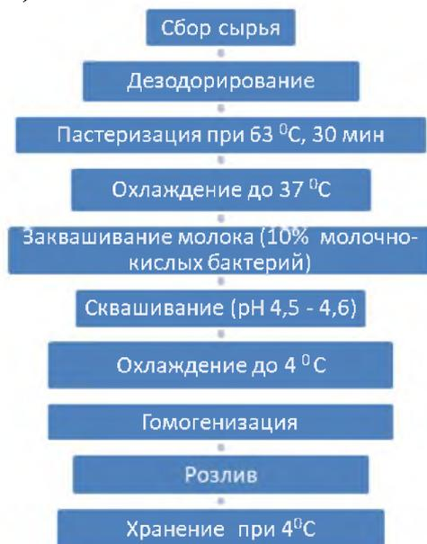
Схема 1. Технологическая схема производства ферментированного напитка из ослиного молока с использованием молочно-кислых бактерий
