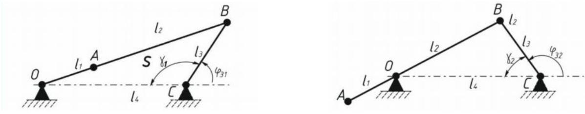
Рис. 2.9. Схемы для определения угла качения коромысла
