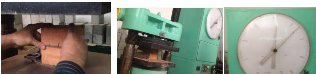
Рис 3.9. Экспериментальное исследование кирпича на прессе
