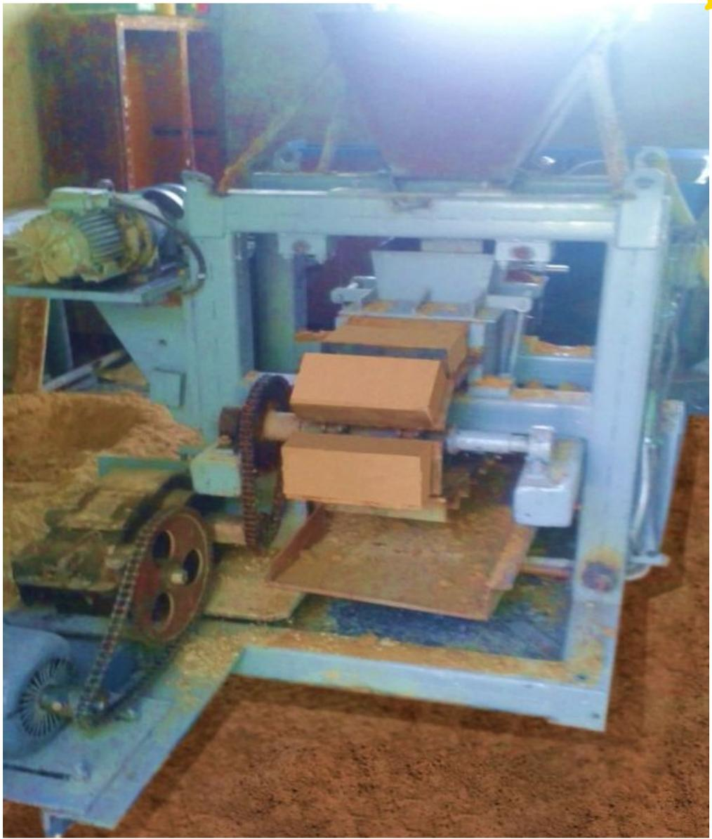
Рис. 4.6. Изготовленный образец установки непрерывного формования глиняных кирпичей
