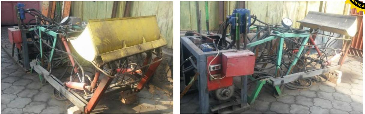
Рис.4.3. Физическая модель бульдозера-погрузчика с трансформирующимся рабочим органом
