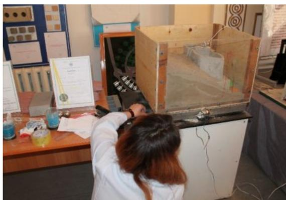
Рис.П.1.3. Испытание модели полурadiaльной стенки
