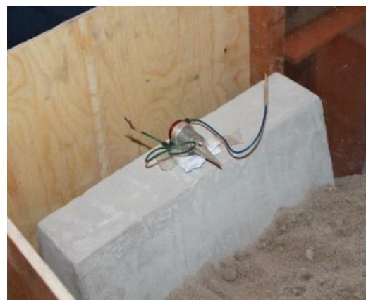
Рис.П.1.2. Измерения показаний модели гравитационной стенки
