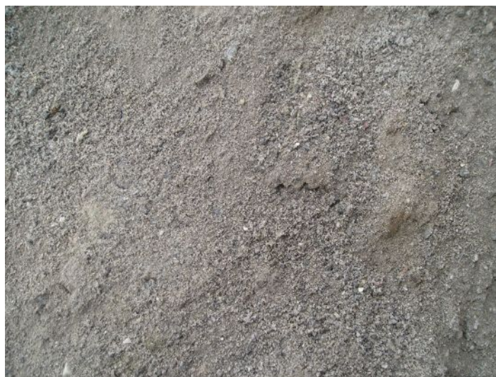
Рис. 2. Отход базальтовой крошки в процессе промывки с водой
