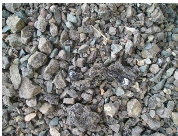
Рис. 1. Базальтовая крошка для производства супертонких волокон
