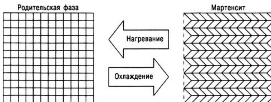
Рис. 1. Схематическое изображение термоупругого мартенситного перехода
