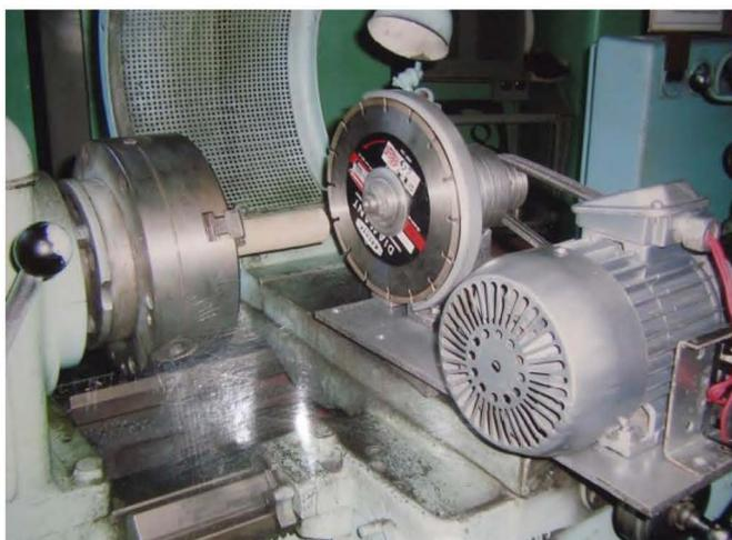
Рис. 3: Технологический модуль с дисковым алмазным инструментом
