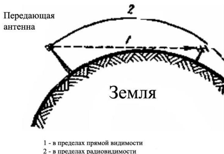
Рис. 1. Распространение ультракоротких волн.
