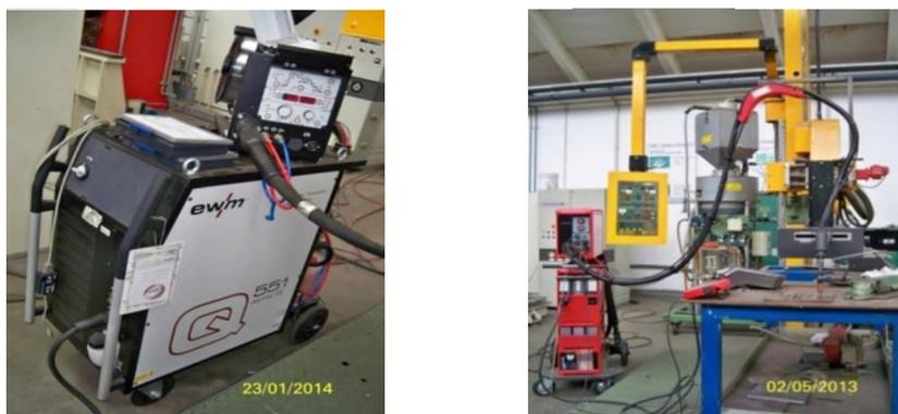
Рис.1. Сварочная установка ISAFc техникой EWM
