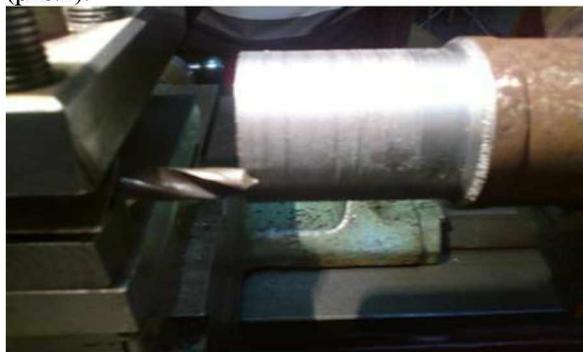
Рис.2. Стенд для исследования характера наростообразования на режущих кромках спиральных сверл
