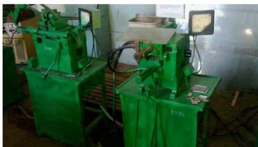
**Bild 2:** Schweißmaschine für Kontaktschweißen ATP – 5
