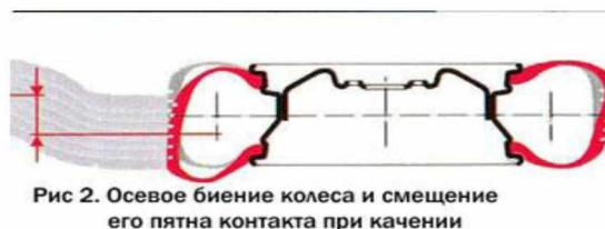
Неравномерность (ударные) нагрузки на протектор в следствие вибрации колеса приводит к существенному снижению ресурса шины – покрышка неравномерно и интенсивно изнашивается (рис.3).
