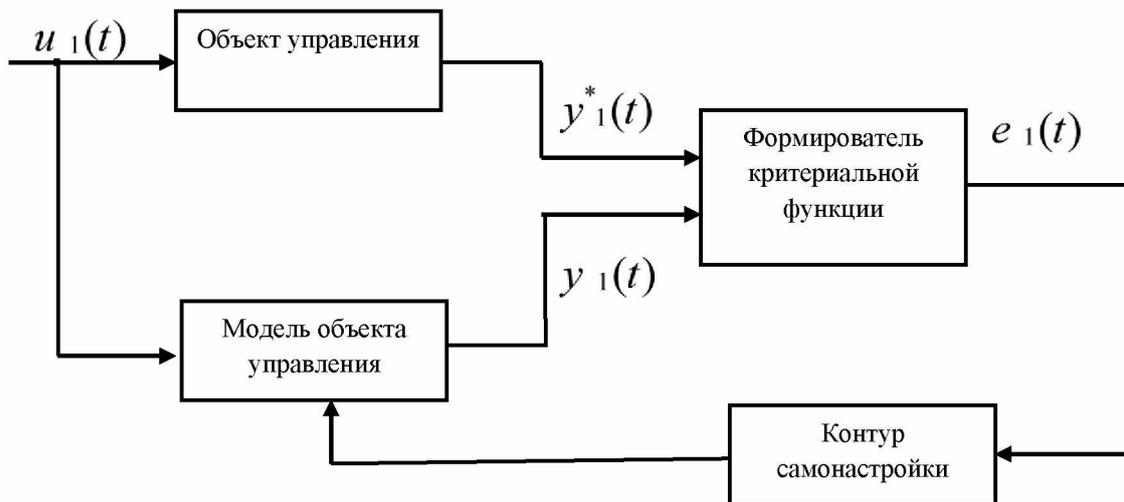
Рис. 2. Общая схема идентификации параметров объекта.
