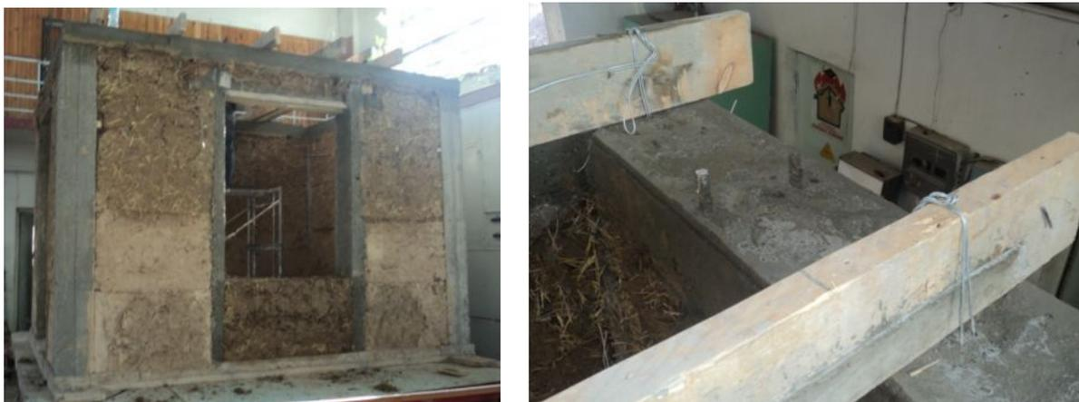
*Рис. 1. Фрагмент модели дома с железобетонным каркасом и заполнением из глиноматериалов.*
