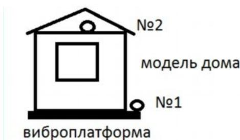
*Рис.2. Схема расположения приборов на модели дома.
