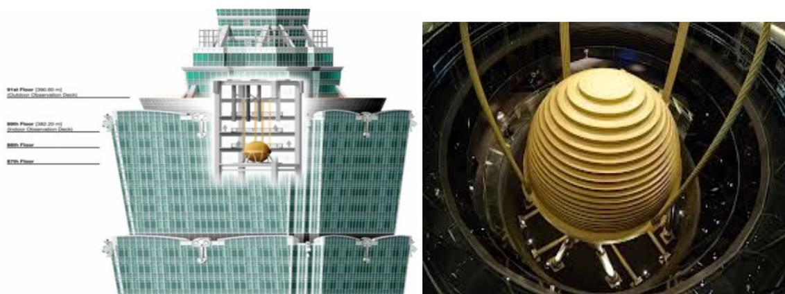
Рис. 1. Инерционный гаситель в Тайбей 101
