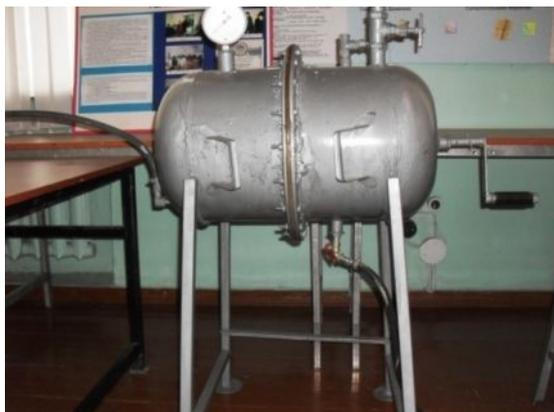
*Рис.1. Устройство для изучения растворимости оксида кальция: 1 - и 2 – цилиндрическая часть корпуса аппарата; 3 – вал перемешивающего устройства; 4 – ручка ; 5 – барботер для  $CO_2$ ; 6 – патрубок для подвода жидкости; 7 – патрубок для подвода реагента; 8 – высоконапорный гибкий шланг для подачи  $CO_2$ ; 9 – манометр для измерения давления внутри аппарата; 10 – патрубок для удаления отработанной жидкости.*
