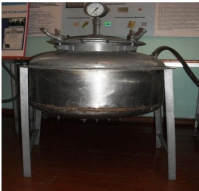
*Рис. 2. Двухступенчатый фильтр: 1 – цилиндрический корпус фильтра; 2 – крышка фильтра; 3 – фильтрующие элементы; 4 – гибкий шланг для подачи воздуха от компрессора; 5 – манометр для измерения давления внутри аппарата.*
