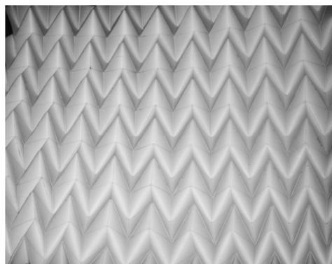
Рис.2. Полученная объемная форма в результате загиба заранее надрезанных линий.
