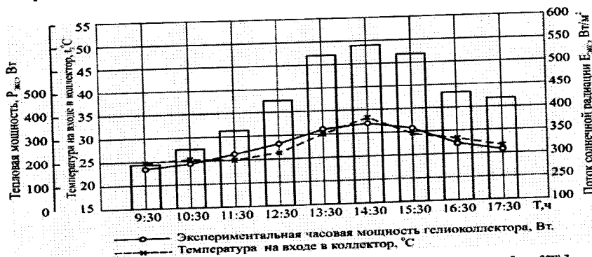
7-сүрөт – Коллектордун кире беришиндеги температуранын [t_3=f(T)] , күн радиациясынын агымынын [E_{жс}=f(T)] жана жылуулук энергиясынын [R_{жс}=f(T)] жылытуу убактысынан T көз карандылыгы.
