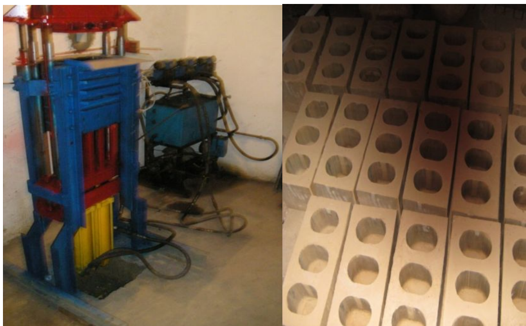
Рис.2. Общий вид установки для производства крупноформатных керамических строительных блоков полусухим способом формования и образцы сырца отформованных блоков Техническая характеристика установки для формования крупноформатных керамических строительных блоков
