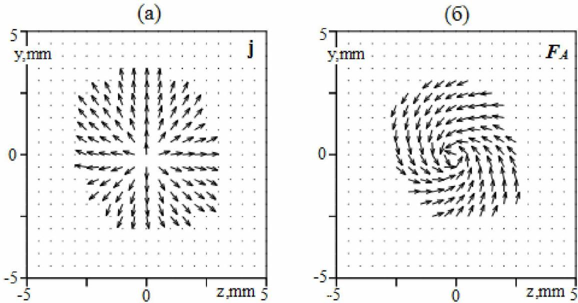
Рис.5. Векторные поля: (а) – плотности электрического тока  $\mathbf{j}$ , (б) – силы Ампера  $\mathbf{F}_A$  в поперечном сечении  $y$ - $z$  на расстоянии 5 мм от катода.
