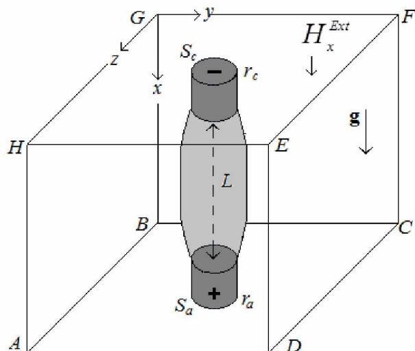
Рис.1. Схема расчетной области в виде прямоугольного параллелепипеда  $ABCDEFGH$  в декартовых координатах  $x$ ,  $y$ ,  $z$  для открытой электрической дуги с цилиндрическим катодом (–) и анодом (+). Пунктирная линия - - - центральная ось дуги.
