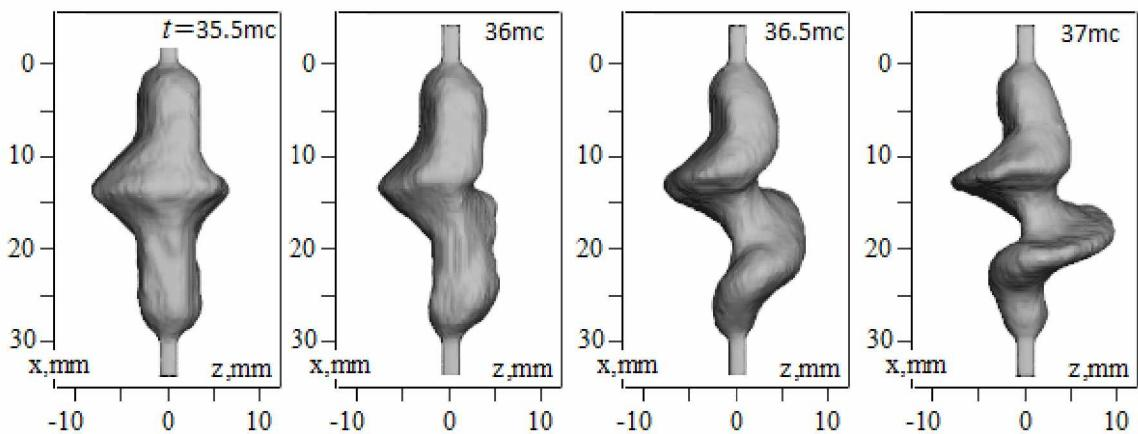
Рис. 3. Изменение формы столба дуги на интервале времени  $\Delta t = 35.5 \div 37 \text{ мс}$ .
