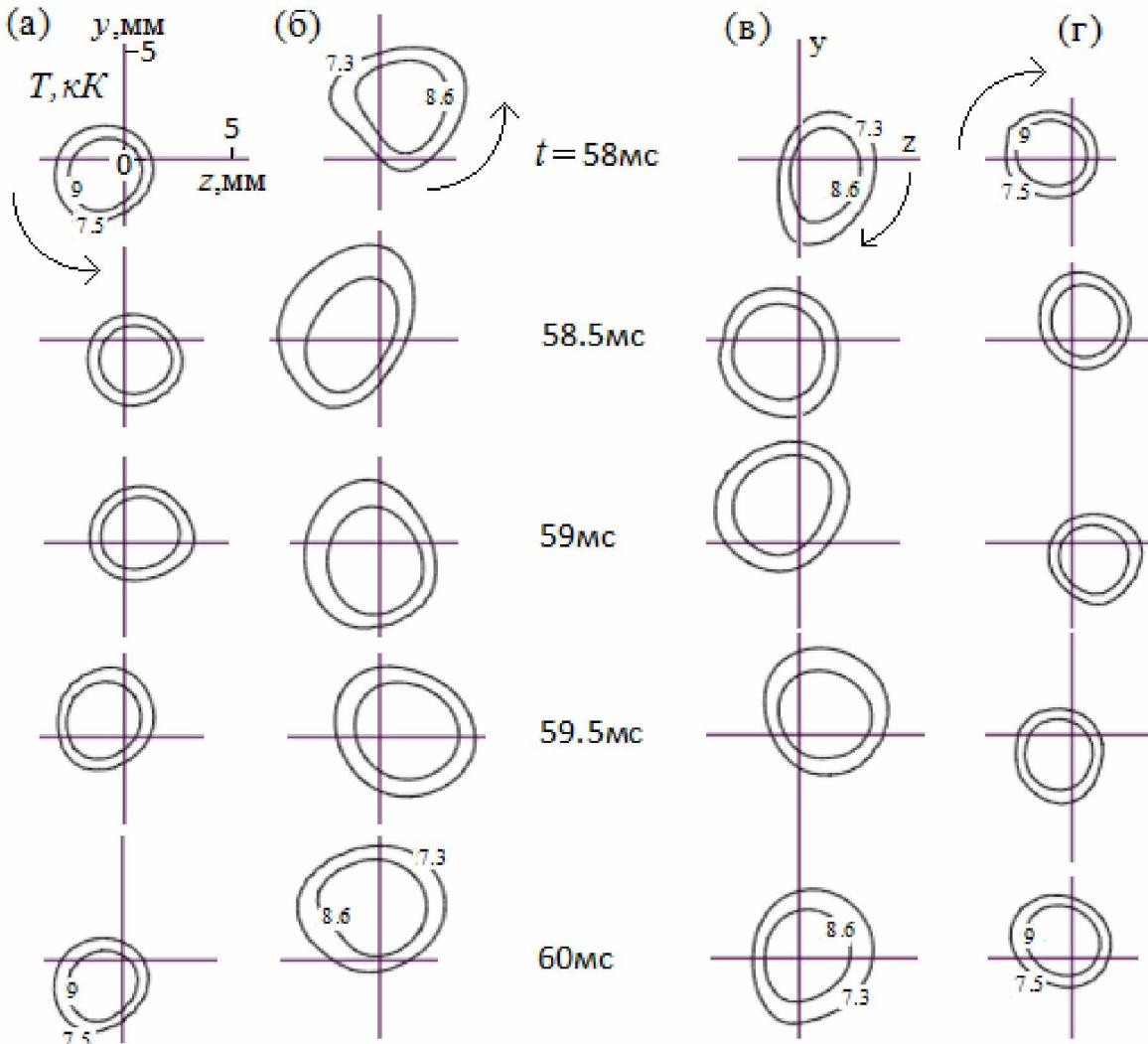
Рис.6. Распределение температуры  $T$  дуги в различные моменты времени  $t$  в различных поперечных сечениях  $y-z$ : столбец (а) – 5мм от катода, (б) – 10мм от катода, (в) – 10мм от анода, (г) – 5мм от анода. Стрелками указано направление вращения.
