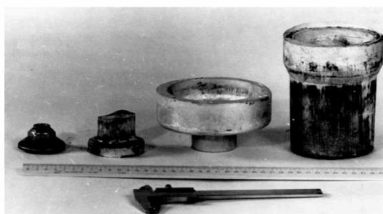
Рисунок 1- Детали «стакан» (АМг5), «корпус» (В48), «крышка» (АК4), «сферическая опора» (Д18Т)
