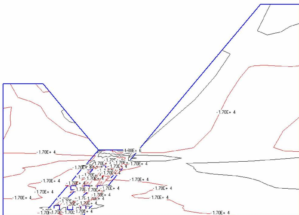
Рис.1. Распределение горизонтальных напряжений в массиве пород до начала очистных работ
