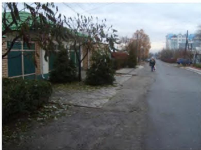
*Рис. 3. Отсутствие тротуара. Частные дома вышли за красную линию, электрические столбы находятся на территории частных владений*
