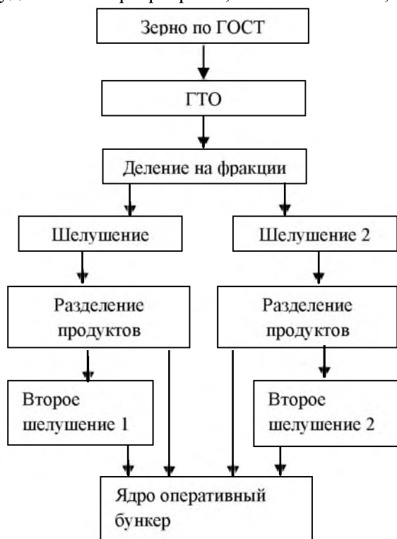
Рисунок 2 – Применяемая схема переработки зерна овса.
