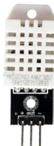
Рис. 3. Датчик DHT22
