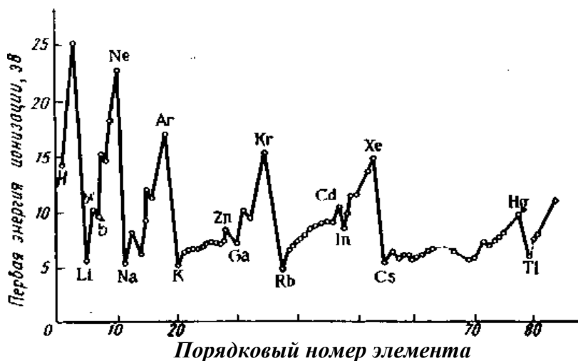
Рис. 3. Зависимость первой энергии ионизации от порядкового номера элемента Z
