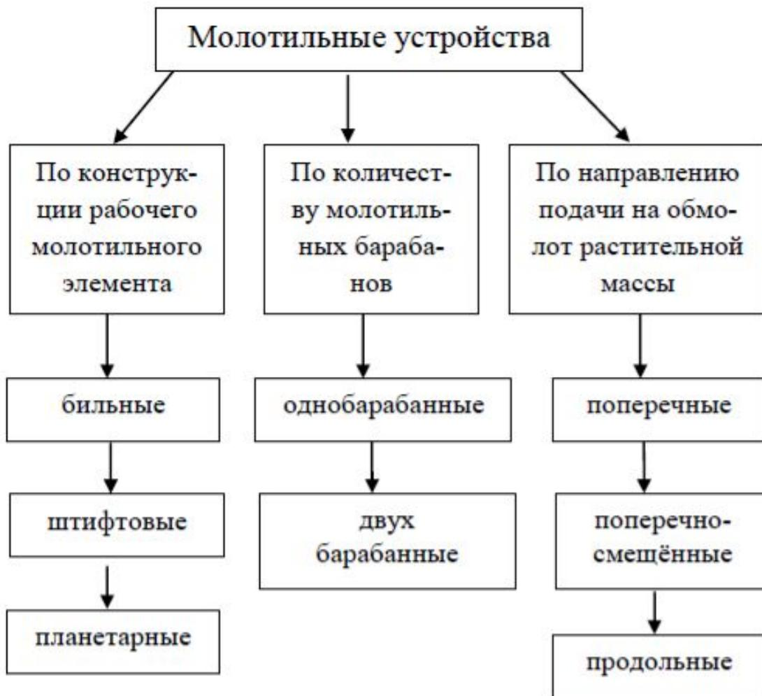
Рис. 1. Классификация молотильных установок
