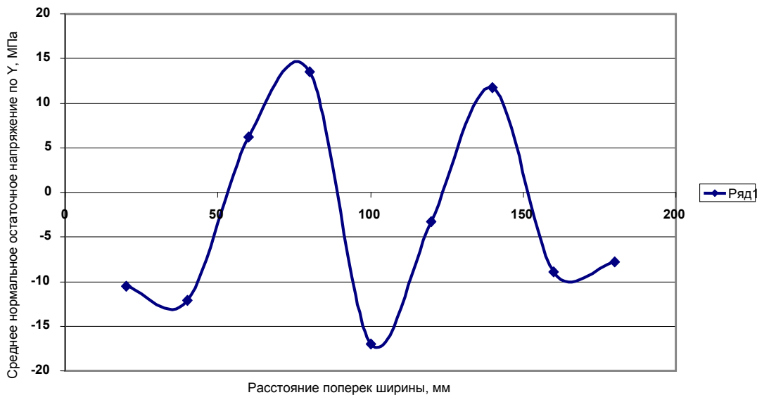
Рис. 1. Среднее остаточное напряжение в модели 2-1 с наведенными остаточными напряжениями: а – вдоль ширины модели; б – поперек ширины модели, ЭД-6.
