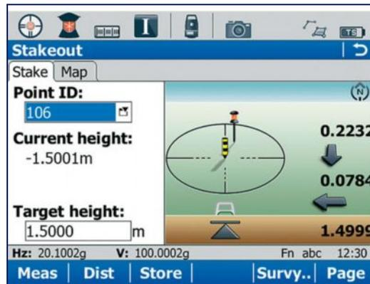
Рис. 2. Дисплей электронного тахеометра при выносе точек в натуру
