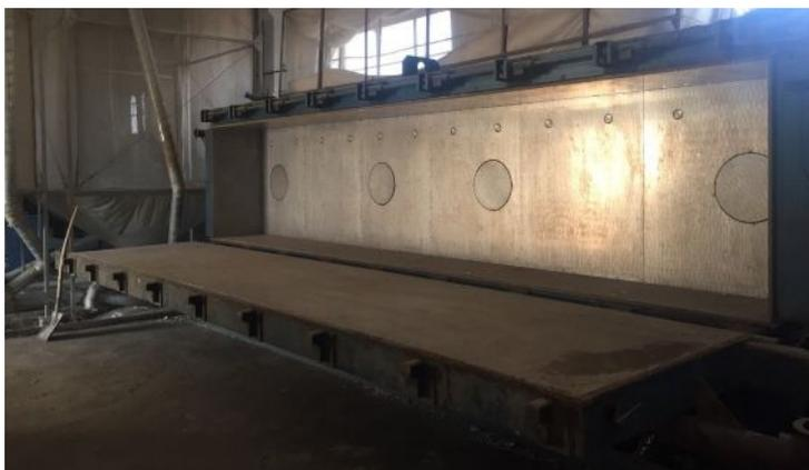
Рис. 3.7. Блок-форма для прессования пенополистирольных блоков
