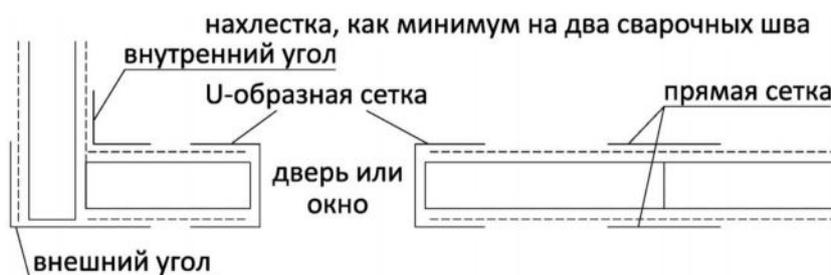
Рис. 4.20. Распределение соединительной сетки
