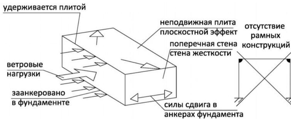
Рис. 4.36. Передача горизонтальных нагрузок
