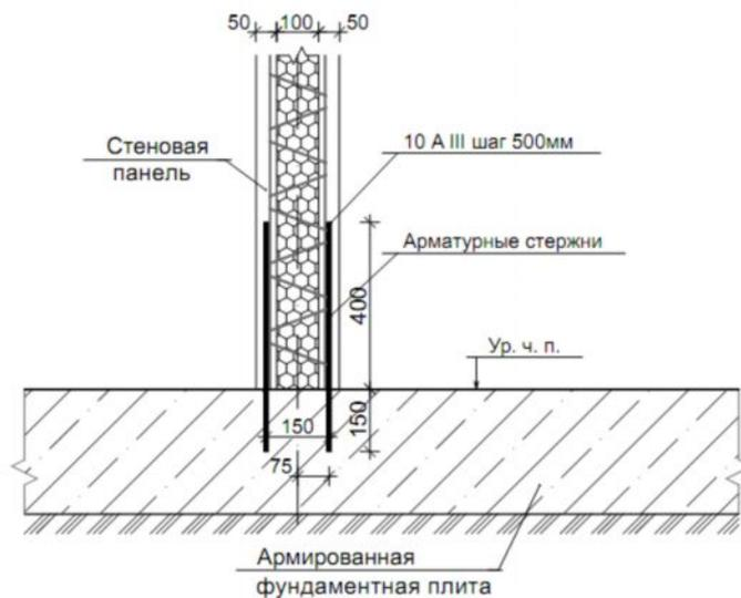
Рис. 4.13. Узел опирания стеновой панели на фундаментную плиту
