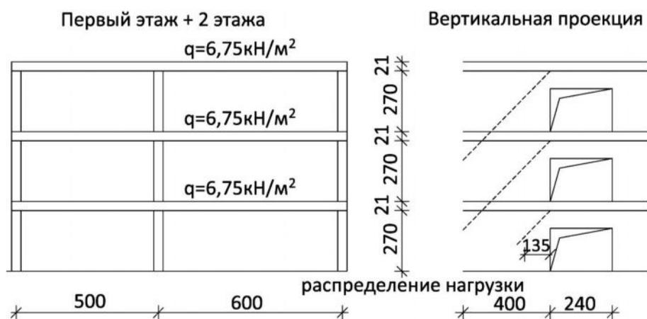
Рис. П 2.3 Поперечное сечение здания и вертикальная проекция внутренней стены
