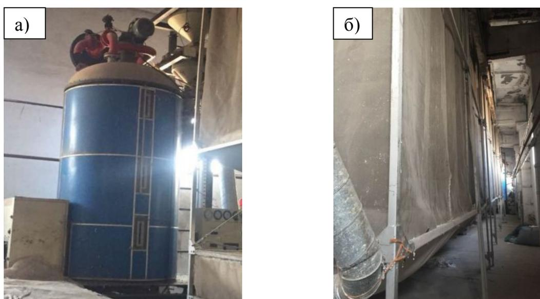
Рис. 3.6. Агрегат для вспучивания пенополистирольных зерен – вспениватель (а) и емкости для воздухообмена (б)
