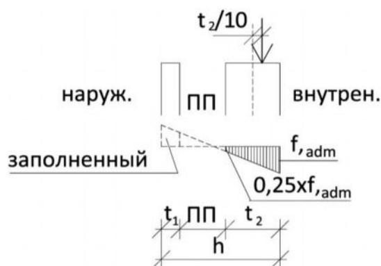
Рис. 4.3. Распределение напряжения в трехмерной стене с различной толщиной каркаса, нагруженной на одну сторону. Случайный эксцентриситет равен  $t_2/10$ .
