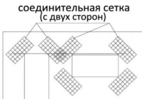
Рис. 4.21. Распределение соединительной сетки. Чтобы избежать 45° трещин в углах дверей и окон, следует устанавливать сетку с 2 сторон.
