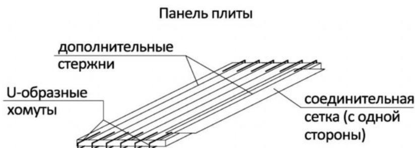
Рис. 4.29. Подготовка панелей плиты перед установкой
