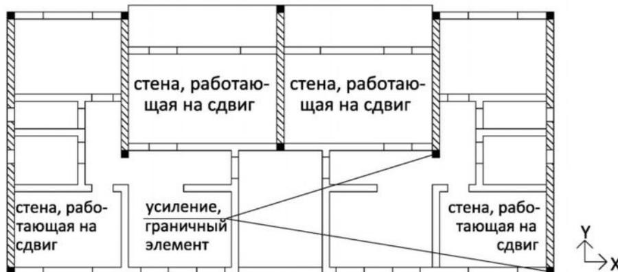
Рис. П 2.6 Схема расположения стен, работающих на сдвиг, с граничными элементами (направление оси y)
