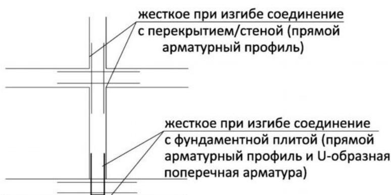
Рис. 4.45. Жесткое на изгиб соединение стены
