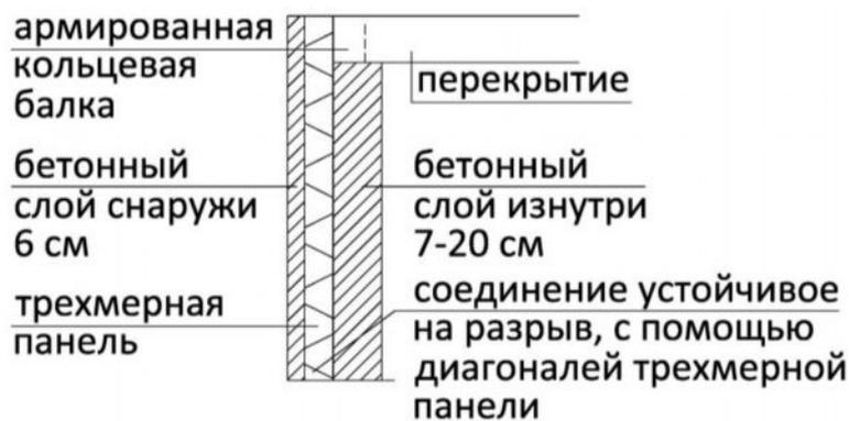
Рис. 4.2. Конструкция трехмерной стены, изготовленной на заводе из легкого бетона (сечение)
