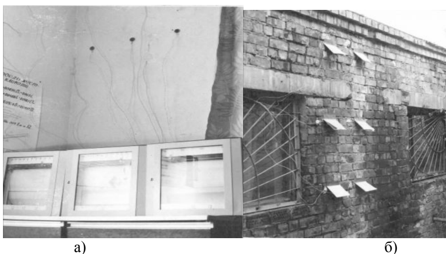
Рис. 1. Общий вид установки по определению теплозащитных качеств наружных ограждающих конструкций ; а – расположение термодатчиков и измерительный блок на внутренней поверхности ограждающей конструкции; б – расположение термопар на наружной поверхности ограждения и их экранирование.
