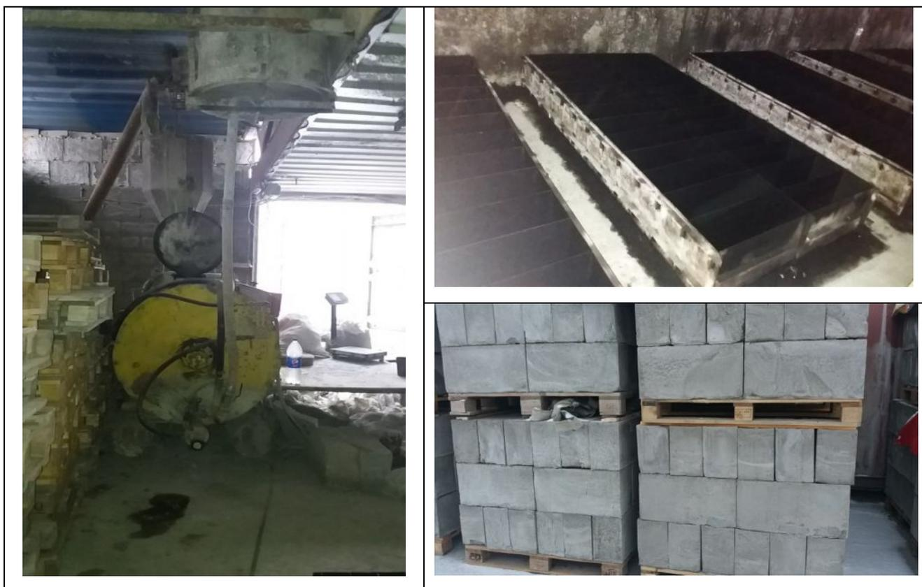
Рис 4.25. Производство неавтоклавного газобетона в ОсОО «Зенит М»
